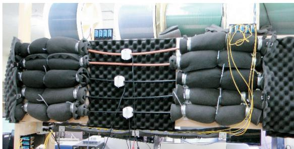
光ファイバケーブル外皮への加振によるセンサ情報伝送技術の検証系
